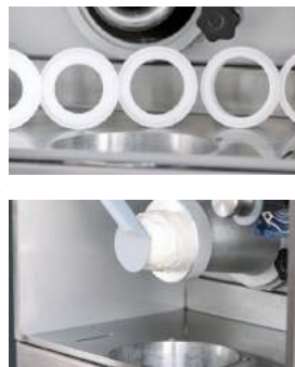
②適切なアダプター希望の量を決める。 自動で押し出された生地をカッターで分ける。
